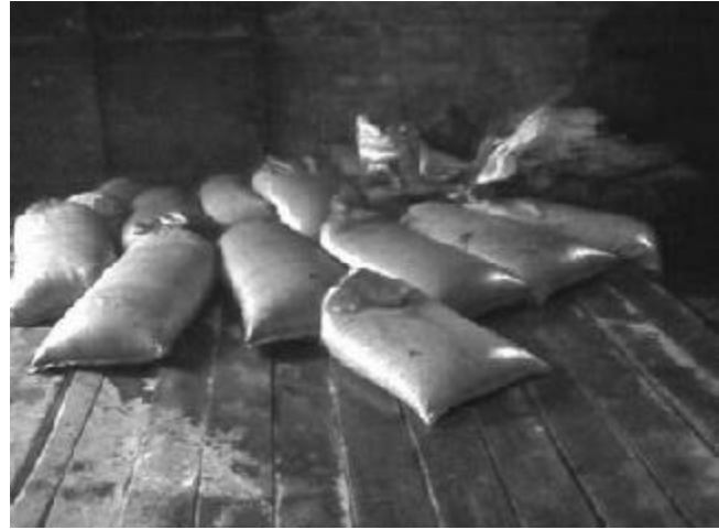
Fotografía 2. Acumulación y deshidratación de sólidos.
